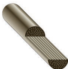
图 2：超长纤维和短纤维粒料的特性
